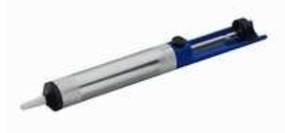
Links een soldeerzuiger en rechts desoldeerdraad.
